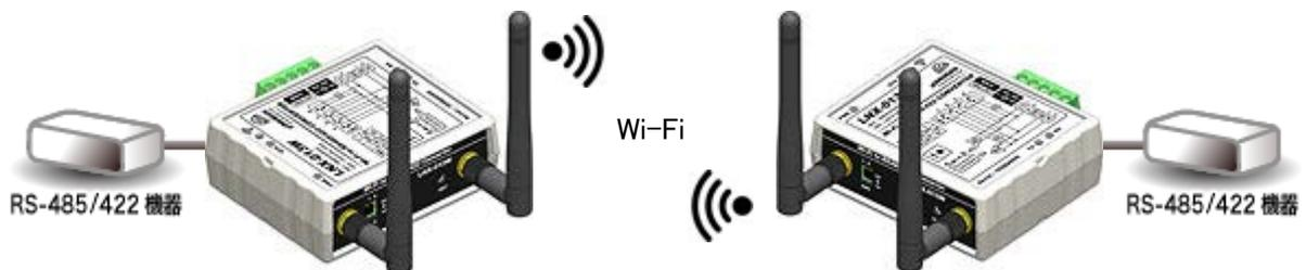
PCの介在なしに LNX-013W 同士が直接通信し、RS-485/422 同士を無線化、延長することができます
