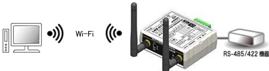
製品内蔵のアクセスポイント機能を使って離れた場所の RS-485/422 機器と通信ができます
