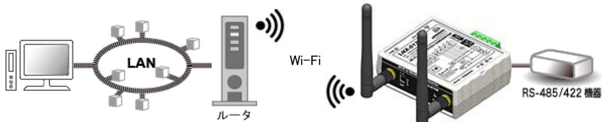
Wi-Fi ルータなどのアクセスポイントを経由して PC から離れた場所の RS-485/422 機器と通信ができます
